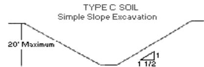
**Figura 8 - Configuración de pendiente normal para un "suelo tipo C".**
